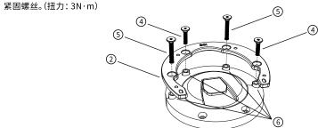
3. 将零件①放置在零件②上方(注意将孔位对齐),放入螺丝,并依次紧固螺丝。(扭力: 1.5N·m)
