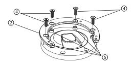
3. 将零件①放置在零件②上方(注意将孔位对齐),放入螺丝,并依次紧固螺丝。(扭力: 1.5N·m)
